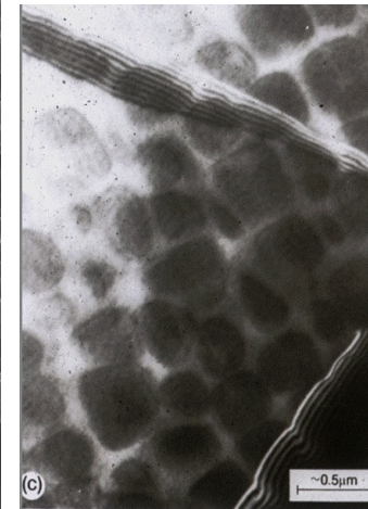
Précipités \text{Ni}_3\text{Al} (10-100 nm)
